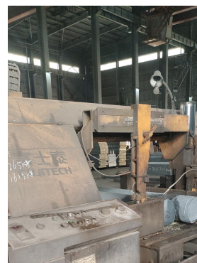
锯床下料时已设置防护罩。
